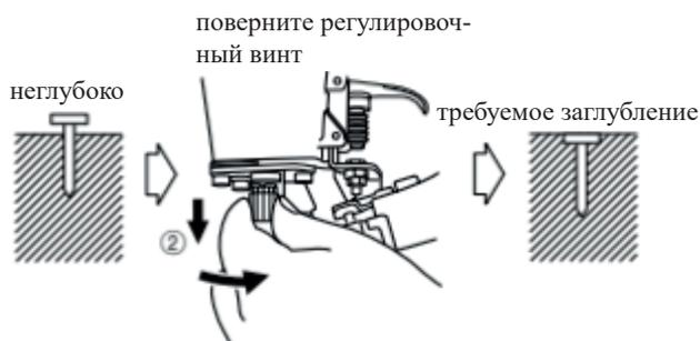
Регулировочный винт может быть зафиксирован на 1/4 оборота.
