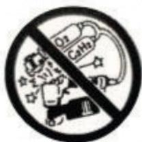
Инструмент предназначен для работы на сжатом воздухе. Не используйте инструмент на каком-либо другом газе (например, кислороде, ацетилене и т.д.), так как существует опасность взрыва. По этой причине ни в коем случае не используйте для работы инструмента ничего кроме воздушного компрессора.
