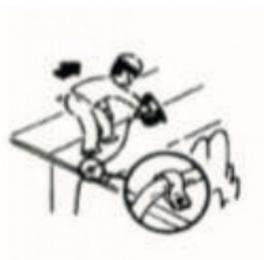
При креплении крыш или подобных наклонных поверхностей начинайте крепление с нижней части и постепенно продвигайтесь вверх. Крепление в обратном направлении опасно, так как вы можете потерять место опоры. Закрепите шланг в точке, близкой к месту, куда вы собираетесь вбивать крепеж. Несчастные случаи могут быть вызваны непреднамеренным натягиванием шланга или его зацеплением.
