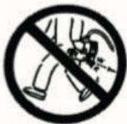
Когда инструмент подключен к подаче воздуха, никогда не трогайте курок, если вы не намерены использовать инструмент в работе. Также опасно передвигаться с инструментом с нажатым спусковым курком, поэтому следует избегать таких и подобных действий.
