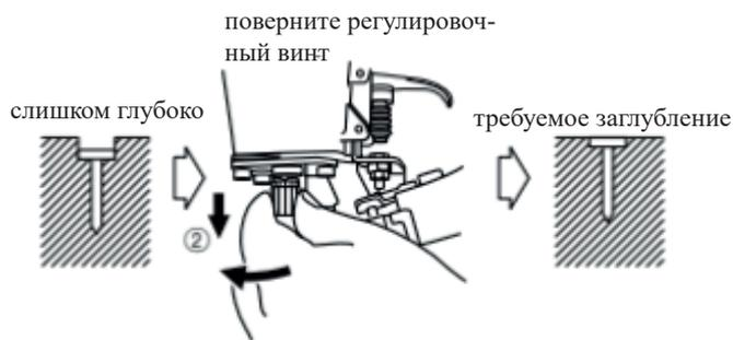
Если гвозди не добиваются, поверните регулировочный винт в сторону увеличения углубления
